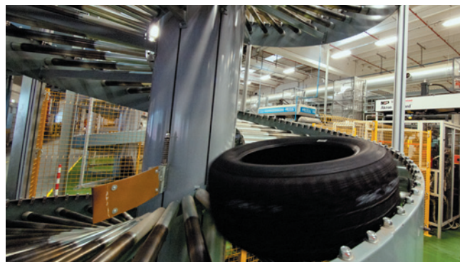
Il codice a barre sullo pneumatico aiuta le operazioni di Finitura
